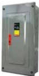
CCR12T-Gris CCR12TW -Blanco 12 circuitos 3 Fases 4 Hilos 240V~ ó 48V.C.D. 60 Hz. Gabinete tipo NEMA 1 (usos generales)
