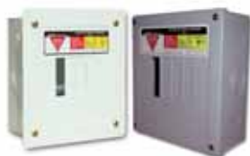
CCR04E, CCR04S - Gris CCR04EW, CCR04SW -Blanco 4 Circuitos 1 Fase 3 Hilos 240/120V~ 60 Hz. 60A máximo.
