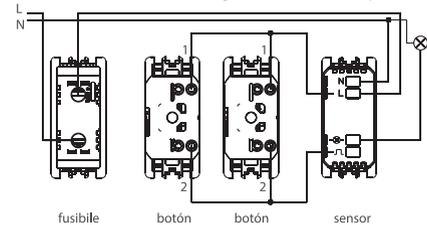
Ejemplo de conexión a un comando de carga a través de dos sensores y dos botones.
