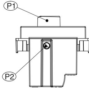
1. Se ajusta el potenciómetro principal (P1) a un promedio de 10% de su rango, se deberá colocar justo antes del OFF total del potenciómetro principal. (En este paso es probable que las lámparas no apaguen o se encuentren en flasheo).
