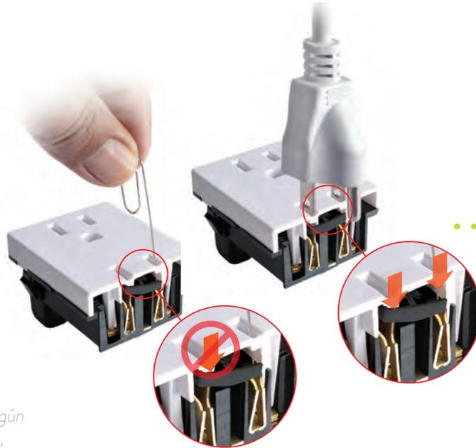
Cuando se introduce algún objeto en un solo borne, el sistema interno bloquea la entrada.
