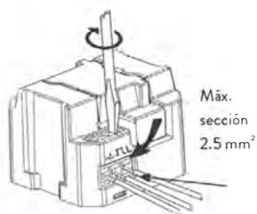
2. Esquema de conexión
